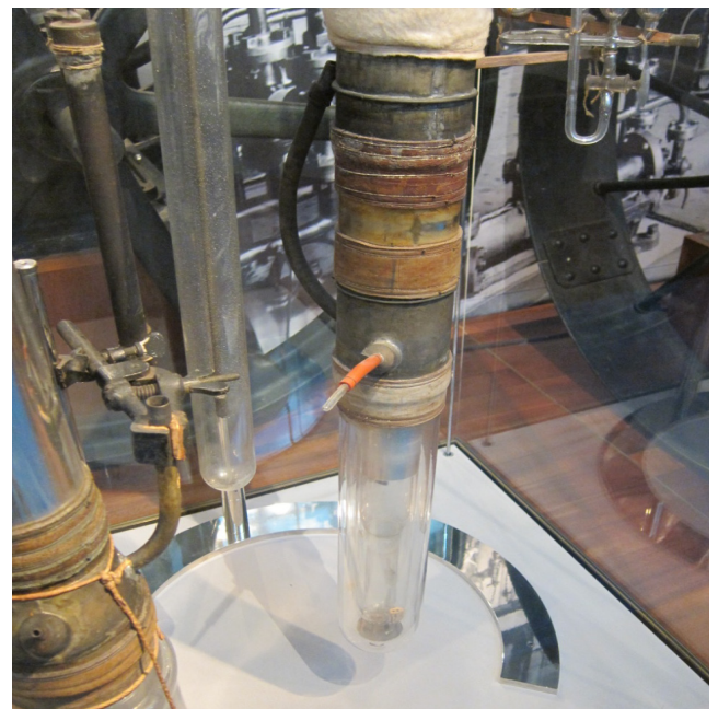
รูปที่ 5 อุปกรณ์ Dewar ในระบบผลิตฮีเลียมเหลวของ คาเมอร์ลิงท์-ออนเนส จัดแสดงที่ มหาวิทยาลัยไลเดน ประเทศเนเธอร์แลนด์
